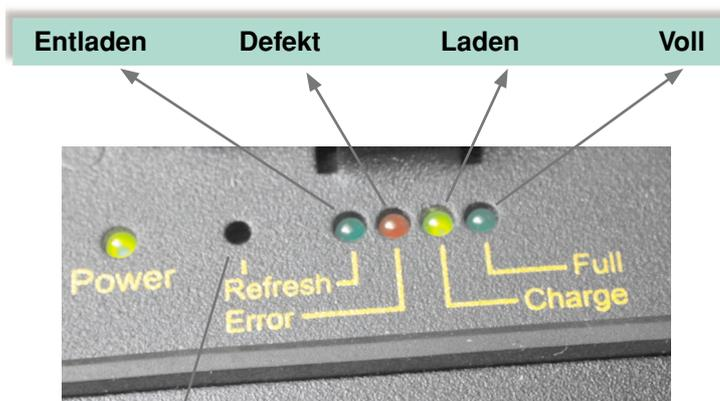
Die Entladefunktion wird über einen verdeckten Schalter aktiviert. Mit einem dünnen Stift kann hier die Entladung gestartet werden.
